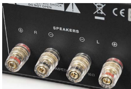
Pojedyncze odczepy transformatorów głośnikowych nominalnie zoptymalizowano dla 6 \Omega , ale bez obaw możemy podłączyć kolumny 8- i 4-omowe.
